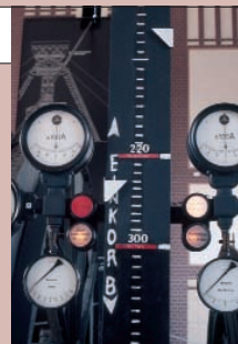
Der Teufanzeiger der Fördermaschine zeigt den Stand der Förderkörbe an.
